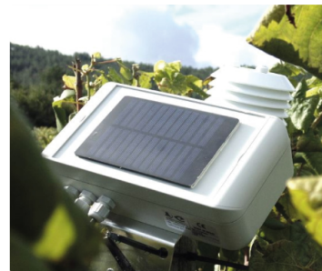
Fig. 15 Sensor de variables ambientales en cultivos. Fuente: https://enviraiot.es/monitorizacion-de-cultivos/
