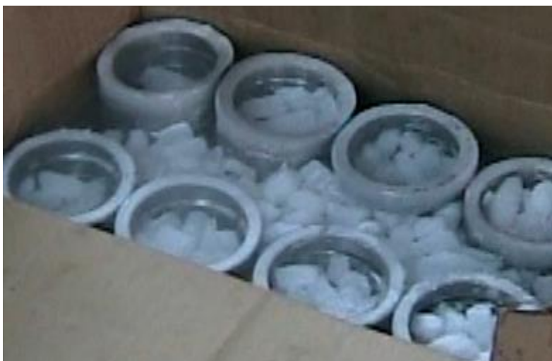
Figura 15. Asientos en enfriamiento con hielo seco
