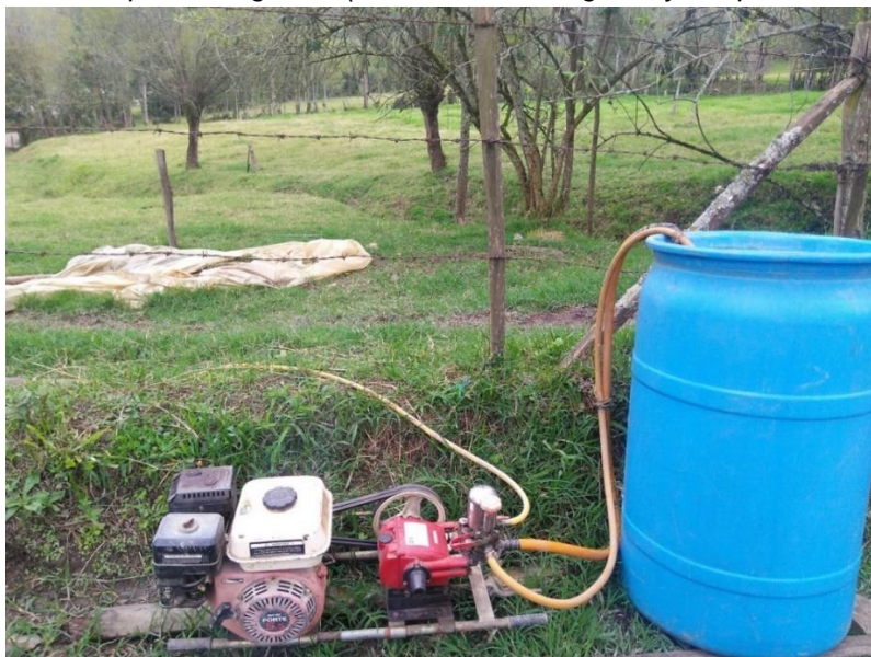
Figura 14. Elementos para fumigación (motobomba, manguera y tanque de almacenamiento)
