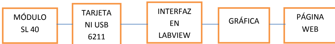
Fig. 1 Diagrama de conexión entre el módulo SL 40 e Interfaz
