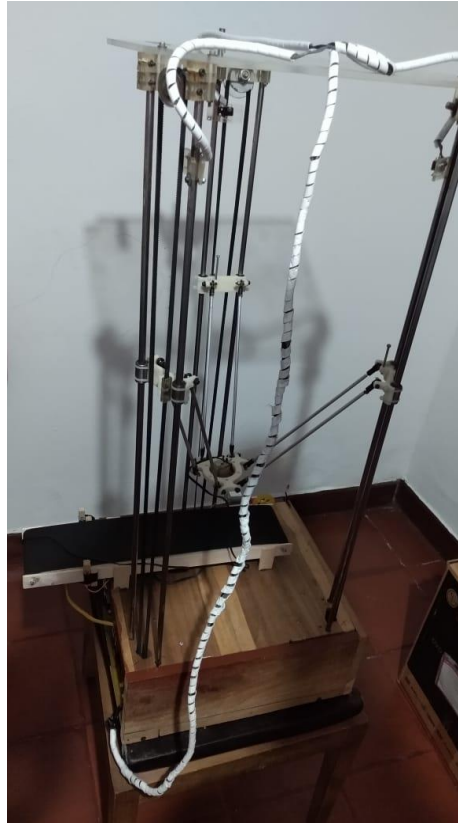
Figura 6. Estructura del robot delta **Imagen de autoría propia
