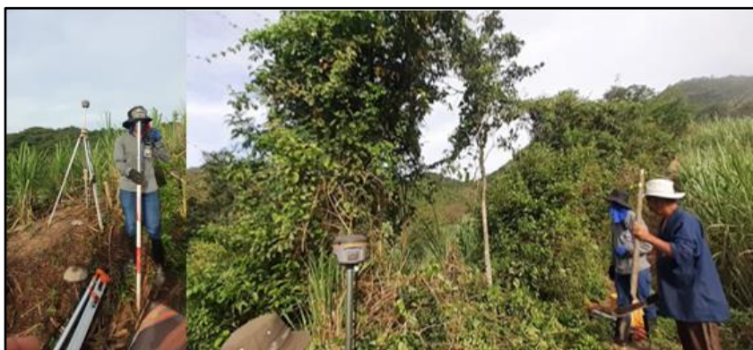
Fotografía 4: Posicionamiento de la base para RTK Fuente: Elaboración propia
