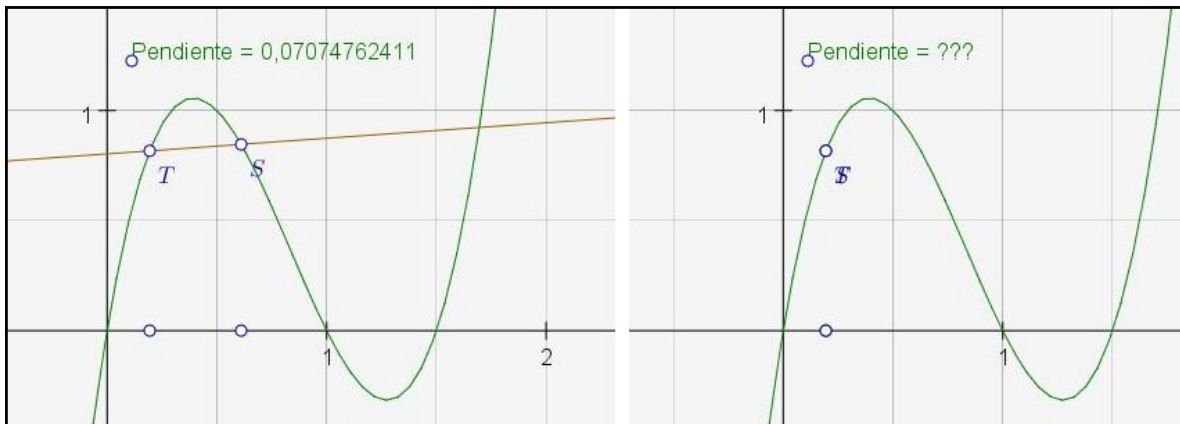
Figura 9. Cálculo de la pendiente de la recta tangente a partir de la recta secante
