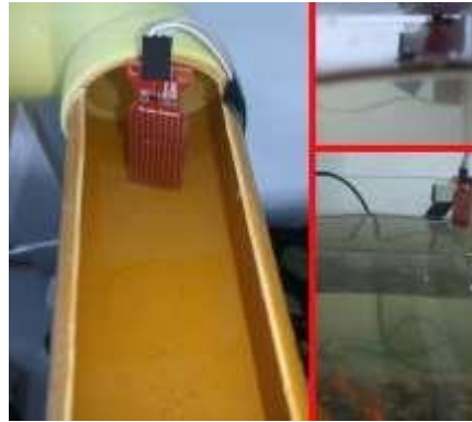
Figura 4 Sensores de nivel de agua. Fuente: elaboración propia.
