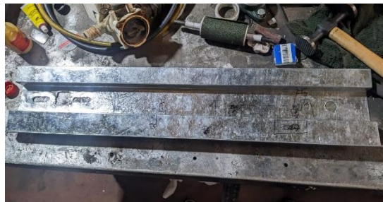
Figura 12. Lamina Estructural Lateral (Fuente Propia)
