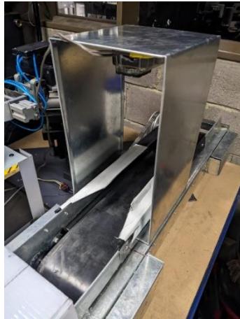
Figura 13. Banda transportadora finalizada con su estructura para la cámara (Fuente Propia)
