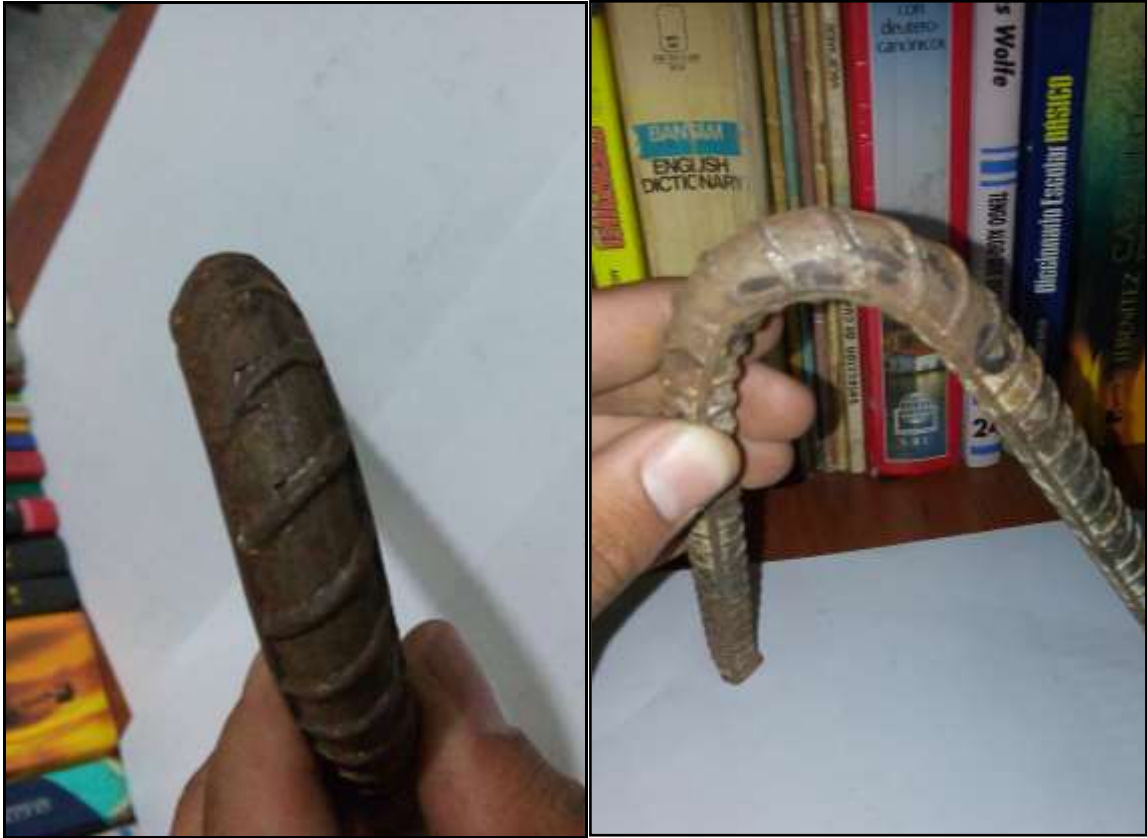
Figura 50. Barra 7 agrietada por doblamiento. Imágenes propias.
