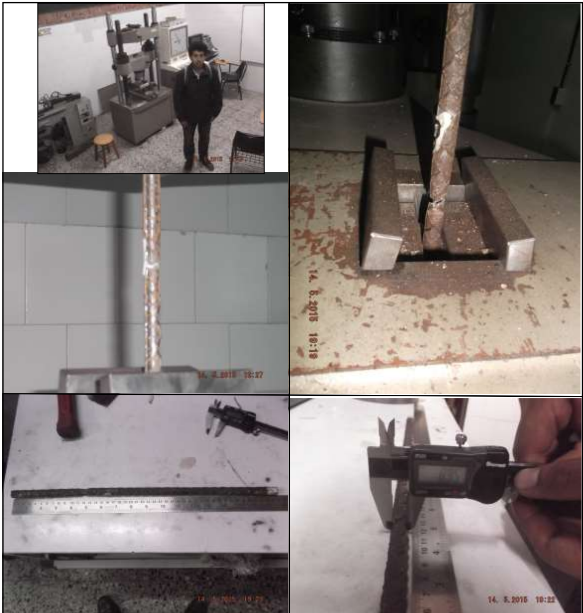
Figura 45. Barras falladas y medición de sus propiedades. Imágenes propias.
