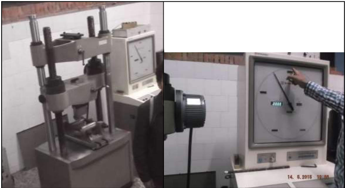
Figura 14. Máquina universal de ensayos, Laboratorio de Resistencia de Materiales, Universidad Distrital, Facultad Tecnológica, Imágenes propias.
