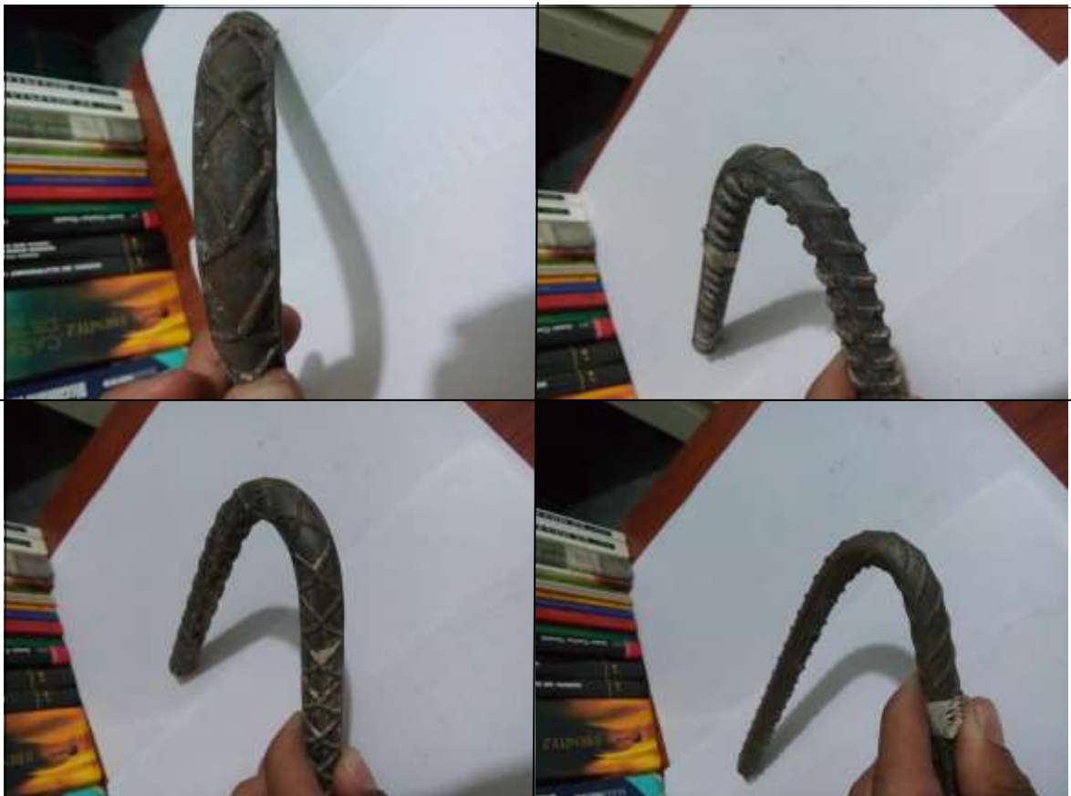
Figura 49. Barras dobladas sin agrietamientos. Imágenes propias.
