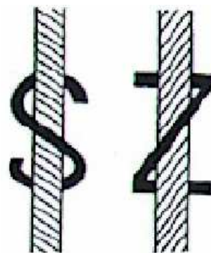
Fig. 1 Sentido de torsión de un hilo
