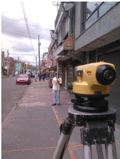
Ilustración 13 .Circuito de nivelación y contranivelacion. (Fuente propia)
