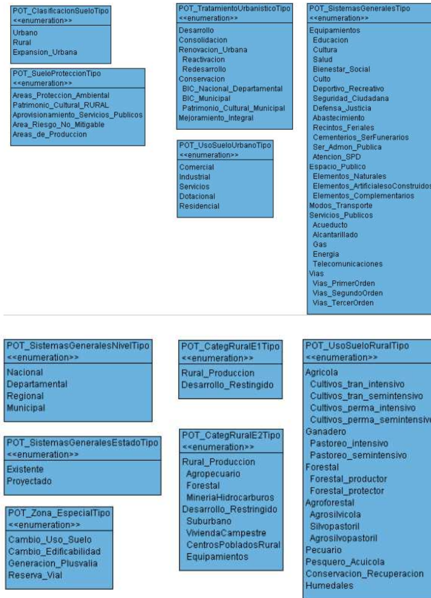
Figura 20 Dominios de la COL_UnidadEspacial del Modelo LADM POT V1.4 Fuente (Departamento Nacional de Planeación, 2020a)
