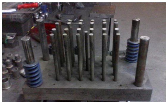
Ilustración 3 Conjunto tapa expulsora, contra placa, amarres, expulsores y guías 1. Fuente propia
