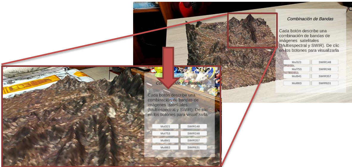
Figura 42. El usuario rodea el target para rotar y se acerca al DEM para zoom.
