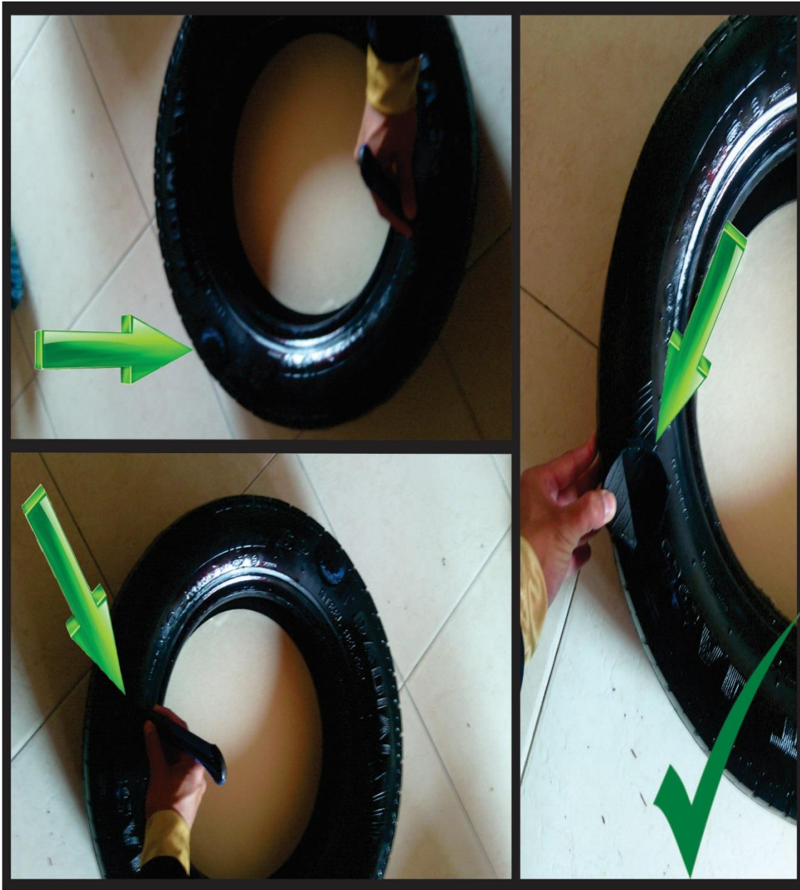
Figura 24. Agujeros en la parte lateral de cada una de las llantas. Fuente: Autores
