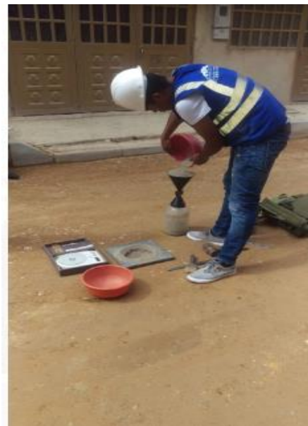
Figura 19. Procedimiento ensayo de densidad Fuente: propia
