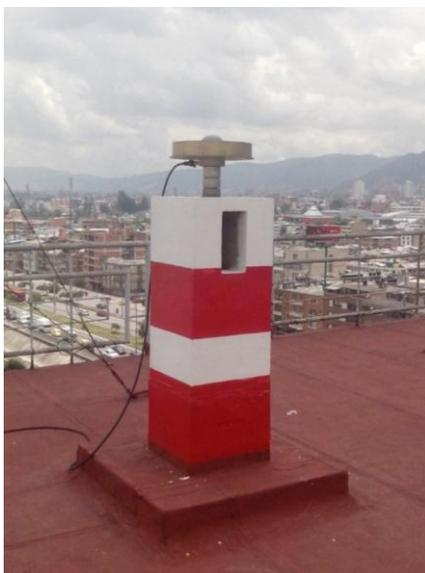
Ilustración 10 Estación de referencia de operación continua (BOGA).
