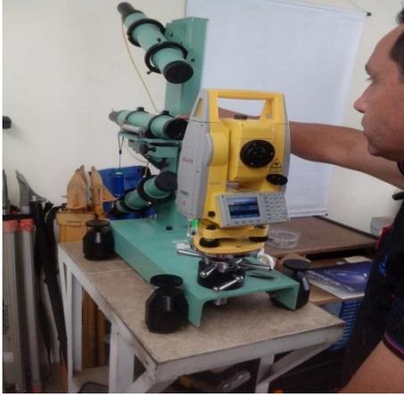
Ilustración 1 Calibración de una Estación Total South.
