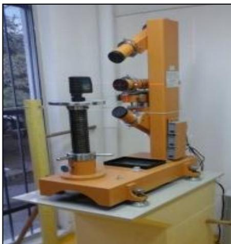
Ilustración 11 Colimador patronado por el fabricante.
