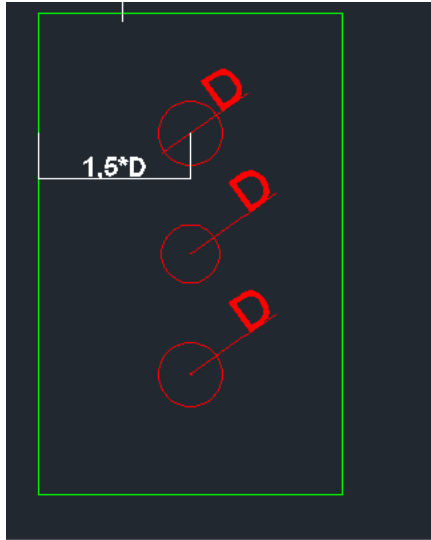
Figura 23. Perforaciones de la barra. Fuente autores
