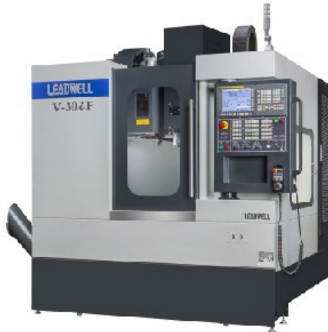
Ilustración 23. Centro de mecanizado vertical Leadwell - Tomado de http://imocom.com.co
