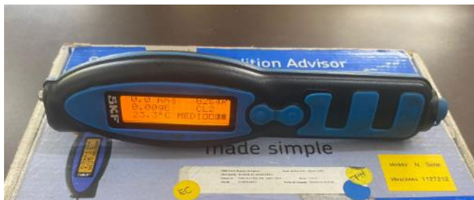
Figura 3 Equipo de Medición SKF Machine Condition Advisor CMAS100-SL
