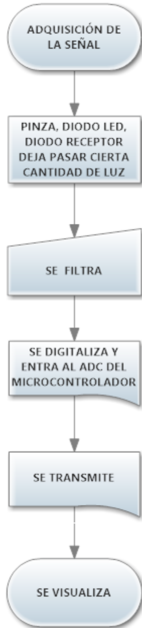
Ilustración 18: Diagrama de Flujo Transmisión de la Señal
