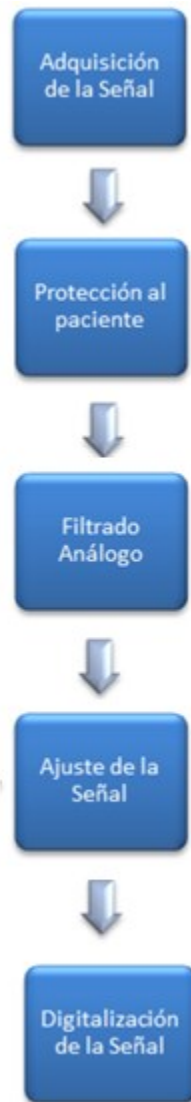
Ilustración 20: Diagrama de bloques del ECG
