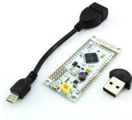
Ilustración 28: Tarjeta IOIO con conector Bluetooth.
