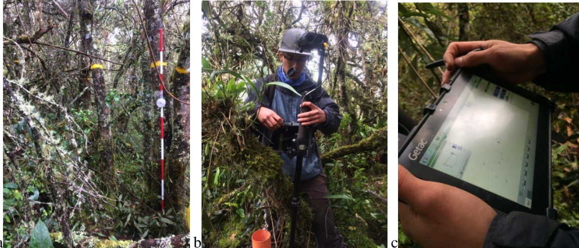
Figura 4. a). Bastón empleado para posicionamiento, b). Equipo integrado (STORK), c). Ordenador de campo ejecutando Field-Map.
