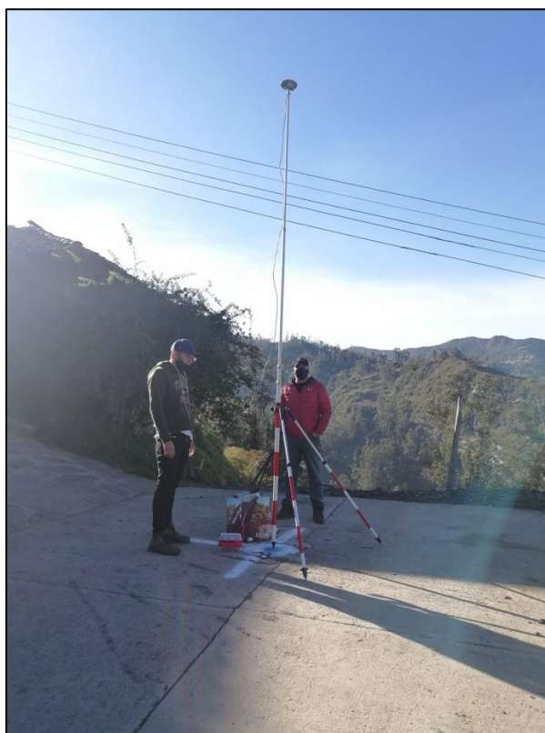
Fotografía 3. Punto tomado en superficie dura demarcado con pintura
