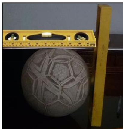
Figura 28. Uso de los dos niveles para garantizar horizontalidad y perpendicularidad de las reglas
