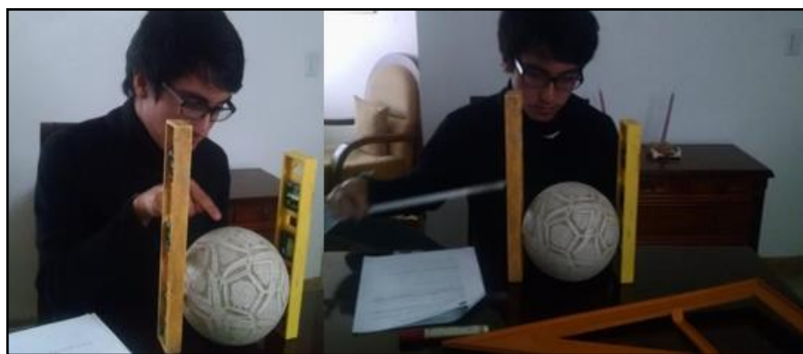
Figura 54. Medición del balón usando los dos niveles.
