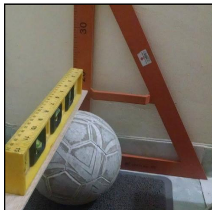
Figura 27. Uso del nivel para validar horizontalidad de la regla no graduada
