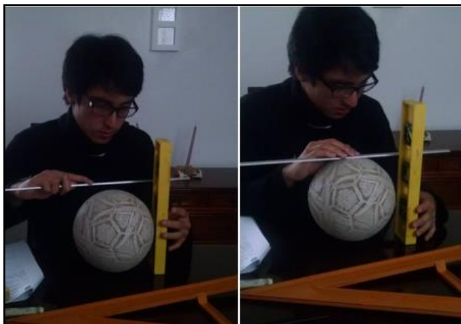
Figura 55. Medición de la altura del balón, teniendo en cuenta que la regla graduada este de manera perpendicular con la mesa.
