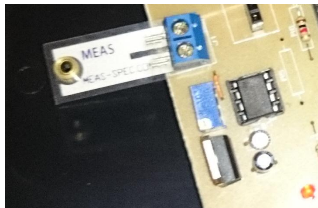
Figura 3. Sensor piezoeléctrico y acondicionamiento de señal
