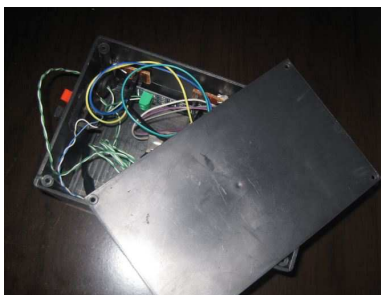
Figura 12. Hardware de protocolo rs485 en el prototipo.
