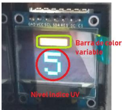
Figura 11. Pantalla OLED indicando nivel UV. Fuente: Elaboración propia de autores.
