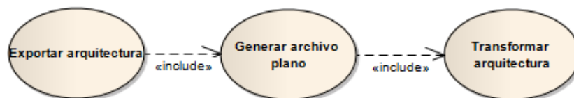
Figura 3.24. Casos de uso implementados en el módulo Transformador.
