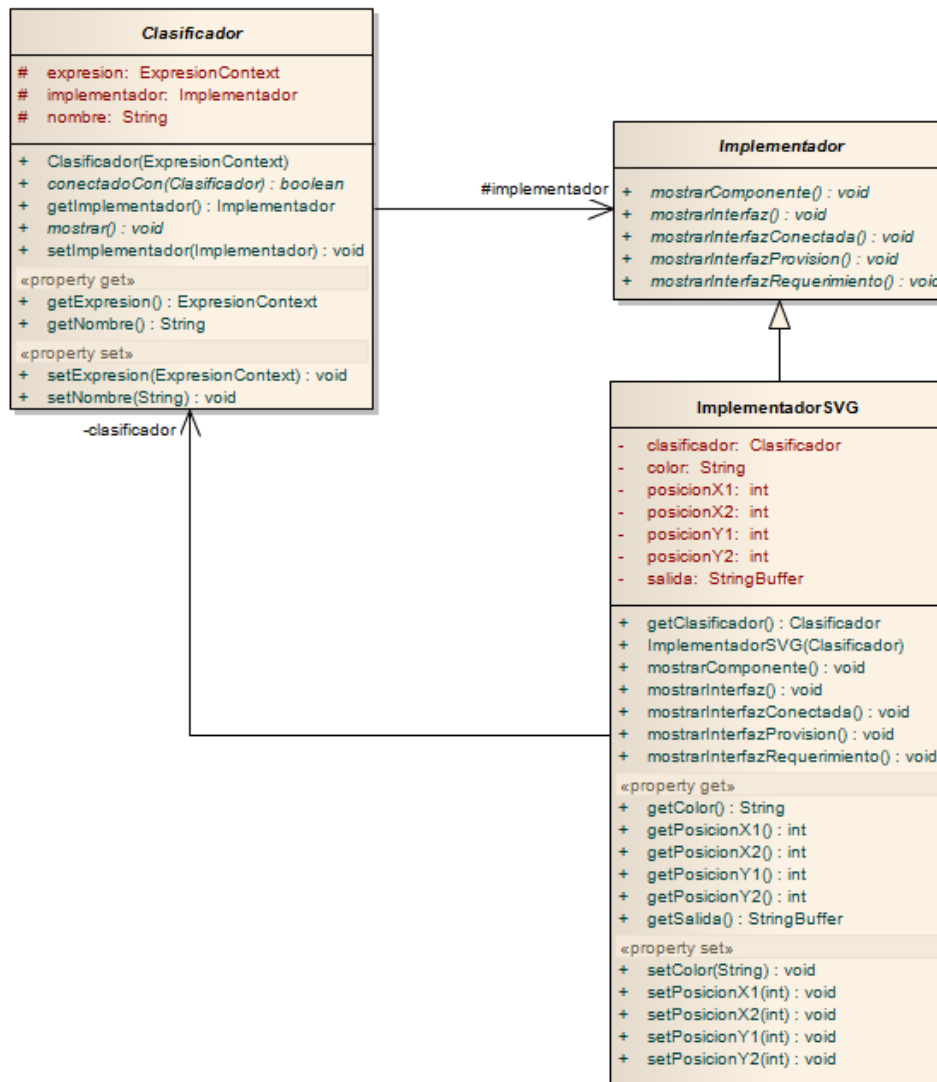
Figura 3.31. Patrón puente para despliegue gráfico de una arquitectura.
