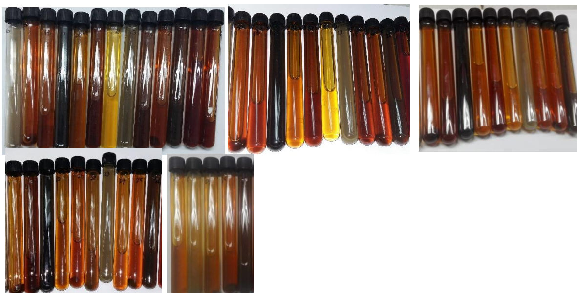
Figura 44. Síntesis de AgNPs con \text{Ag}_2\text{SO}_4 y distintos agentes reductores y estabilizantes luego de 0, 1, 2, 6 y 15 días
