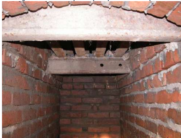
Figura 15. Parrilla tipo riel para producción de panela
