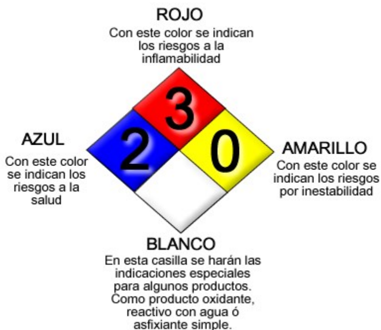
Figura 2. Diamante del peligro. Norma NFPA 704
