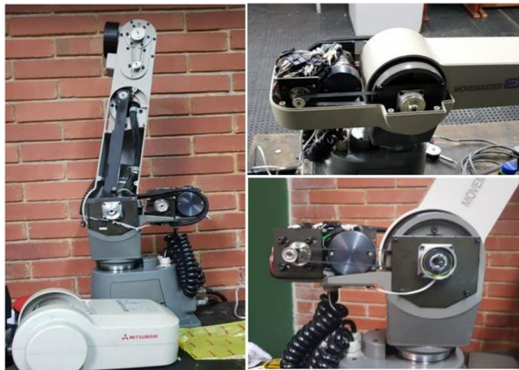
Figura 37. Distribución de elementos internos y trenes de engranaje del brazo robótico Mitsubishi MOVEMASTER RV-M1. (Gomez y Bustos, 2018)
