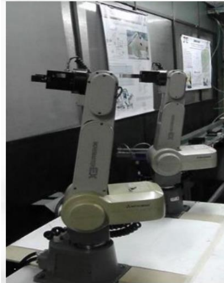
Figura 35. Brazo robótico Mitsubishi Move Master RV-M1 ubicado en el laboratorio de Robótica y CNC de la facultad tecnológica en la Universidad Distrital Francisco José de Caldas. (Laboratorios y talleres de mecánica, 2018)
