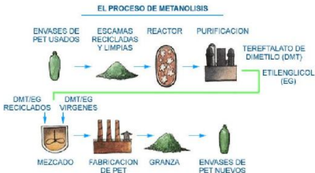
Figura 5. Reciclaje Químico - Proceso de Metanolisis
