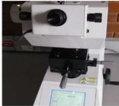
Imagen 15: Toma de micro durezas probetas maquina shinadzu hmv-2
