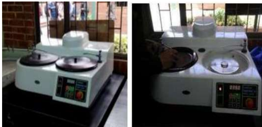
Imagen 14: Preparación de la muestra del material para realizar análisis metalográfico
