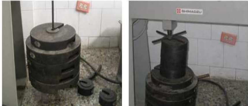
Imagen 13: Cargas que se usaron para el ensayo de fatiga, al lado izquierdo carga de 1020 N, al lado derecho carga de 1100N
