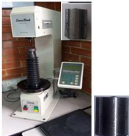
Imagen 18: toma de durezas en probetas AISI/SAE 4140
