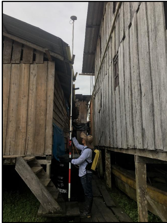
Ilustración 14. Levantamiento linderos con RTK. Fuente propia.
