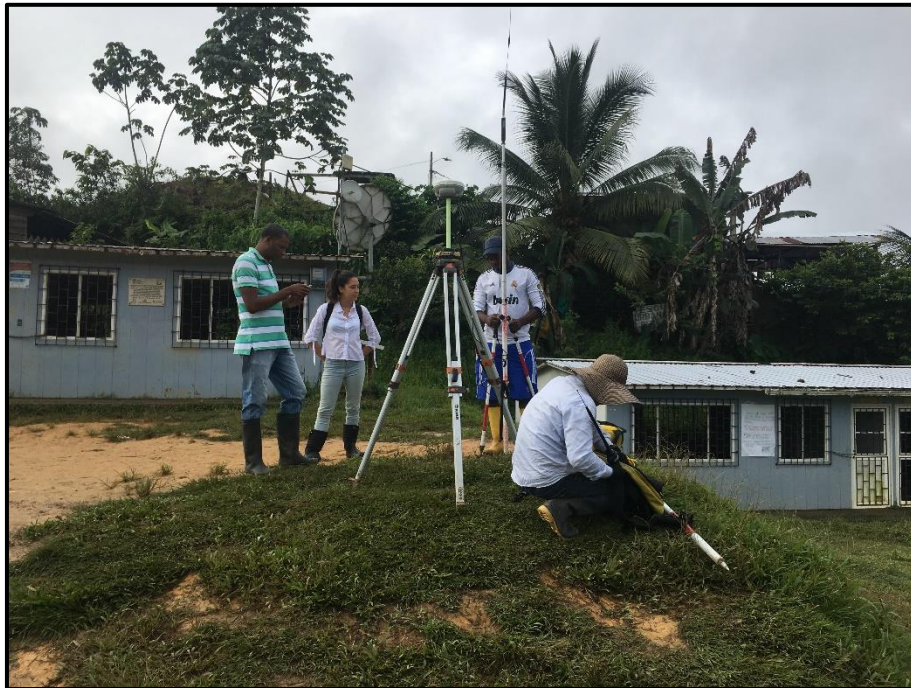
Ilustración 11. Configuración de equipo base para levantamiento RTK. Fuente propia.
