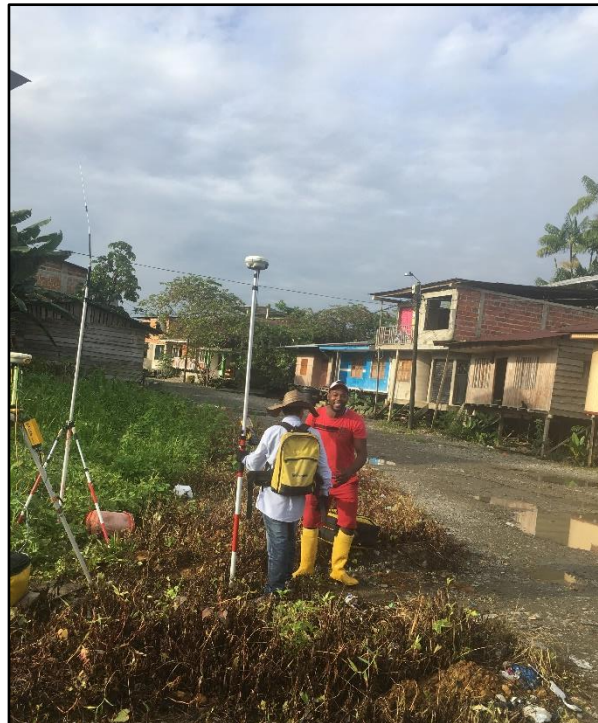
Ilustración 12. levantamiento con RTK. Punto base GPS1. Fuente propia.
