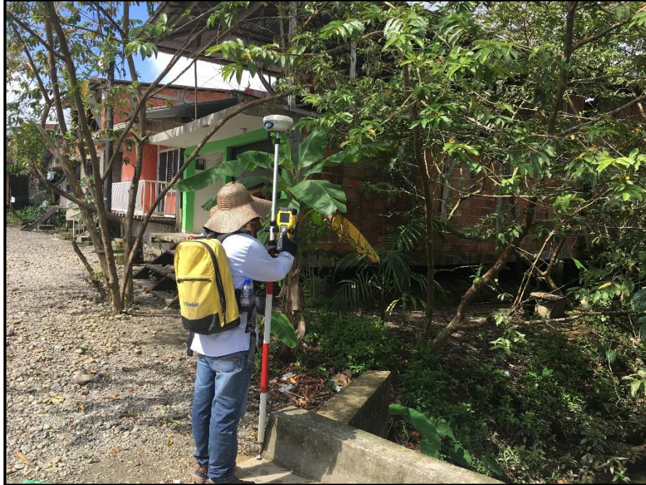
Ilustración 17. Levantamiento vías con RTK. Fuente propia.
