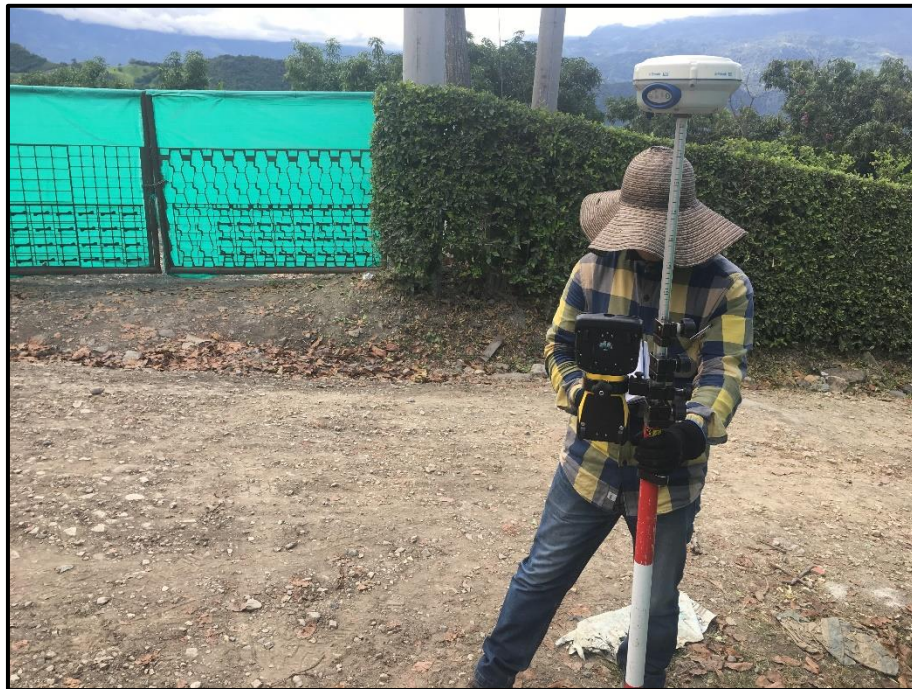
Ilustración 16. Levantamiento zonas aledañas con RTK. Fuente propia.
