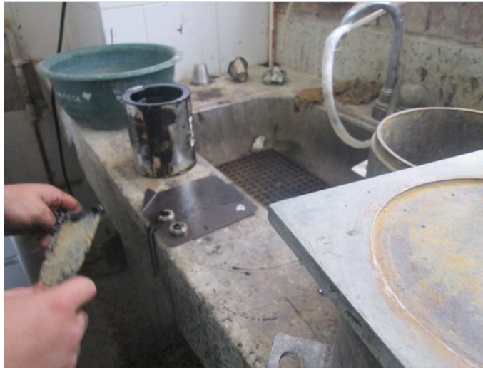
Ilustración 14. Vertimiento de asfalto en molde y montaje del equipo, fuente elaboración propia
