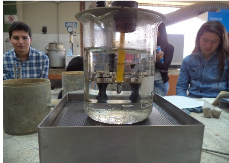
Ilustración 17. Ejecución de ensayo, medición de la temperatura al instante de caída de las esferas, fuente: elaboración propia
