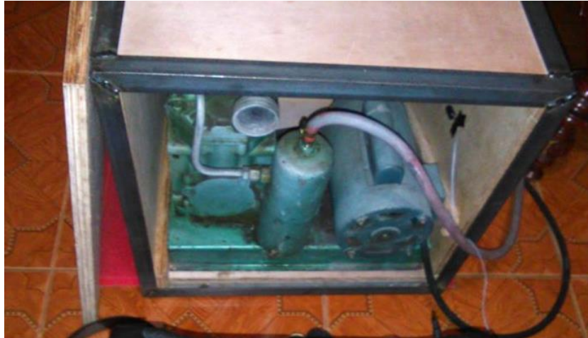
Figura 3.41 Estructura con material triplex de 1.8cm para el compresor.
