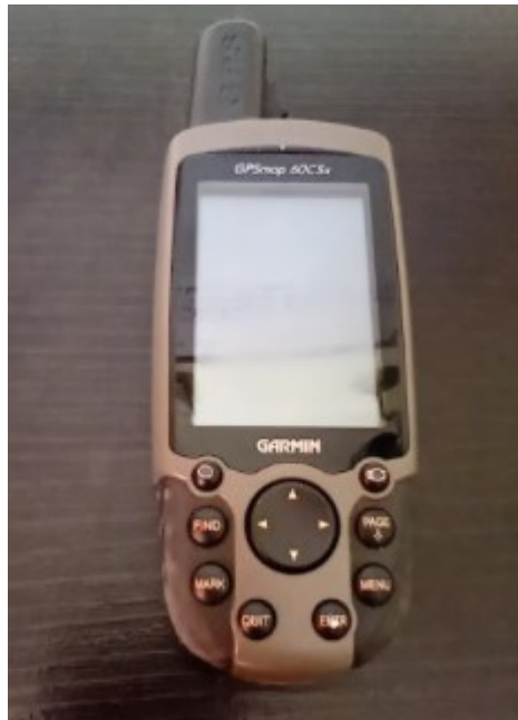
Imagen 12 gps Garmin 60csx, fuente propia
