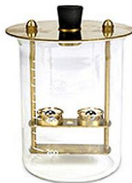
Ilustración 2 aparato de anillo y bola (AM3)
