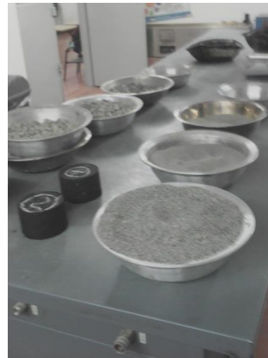
Ilustración 7 Selección y clasificación de los agregados pétreos
