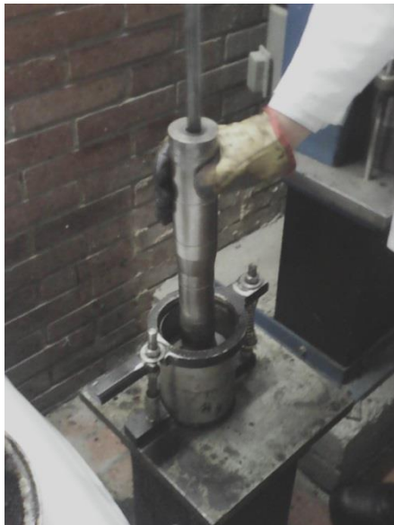
Ilustración 15 Elaboración de Briquetas
