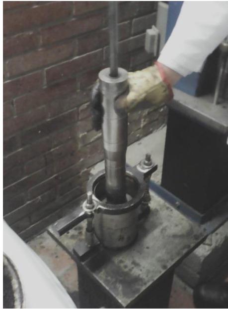
Ilustración 11 Elaboración de la briqueta con la mezcla resultante
