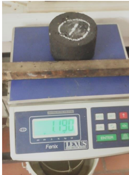
Ilustración 16 Ensayo de Gravedad Específica
