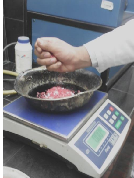
Ilustración 12 mezcla de Cemento Asfático con el desecho de polietileno (PEBD)
