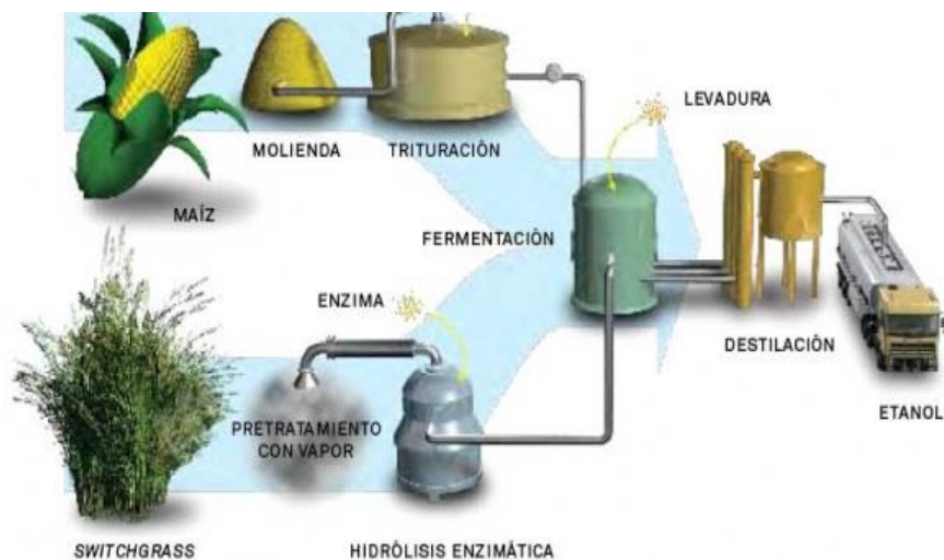
Figura 21. Proceso de fermentación del maíz para la obtención de etanol.
