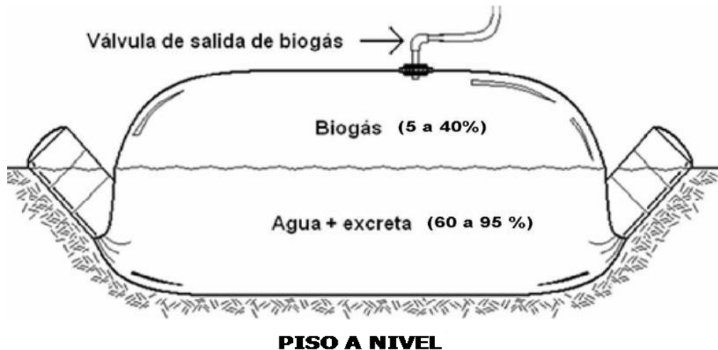
Figura 15. Biodigestor tipo Taiwán.
