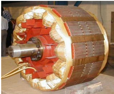
Figura 2. Rotor de un generador sincrónico, (Macri, 2017)
