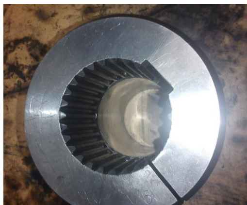
Ilustración 22. Acople motor – eje polea
