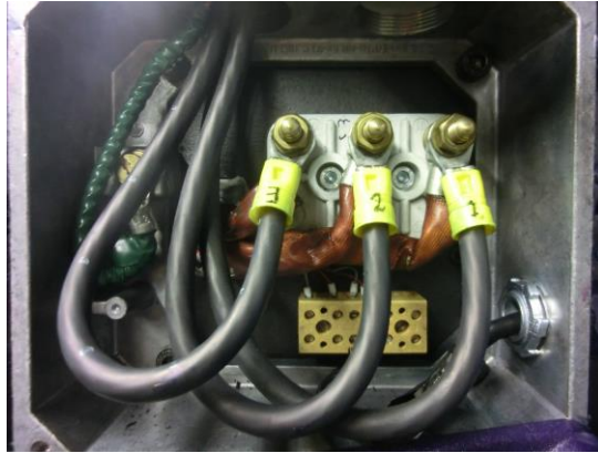
Ilustración 19. Bornera del motor (sin caja hermética)
