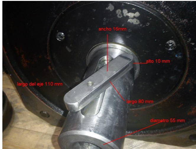
Ilustración 16. Eje del motor y cuña
