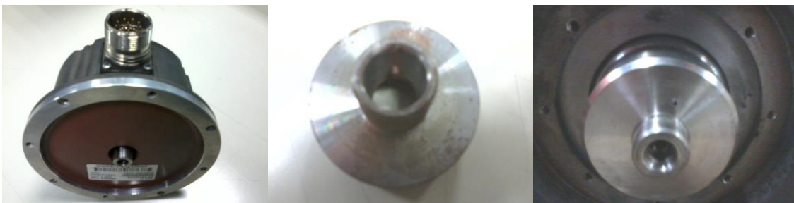
Ilustración 10. Detalle del acople del encoder al motor
