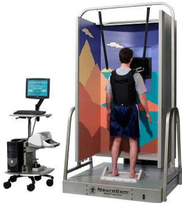
FIGURA 1.1. Laboratorio de posturografía basado en técnicas de procesamiento de imágenes (Tomado de [11]).
