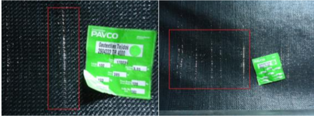
Ilustración 12. Falla de calidad, cinta mal extruida. Fuente: PAVCO Wavin.
