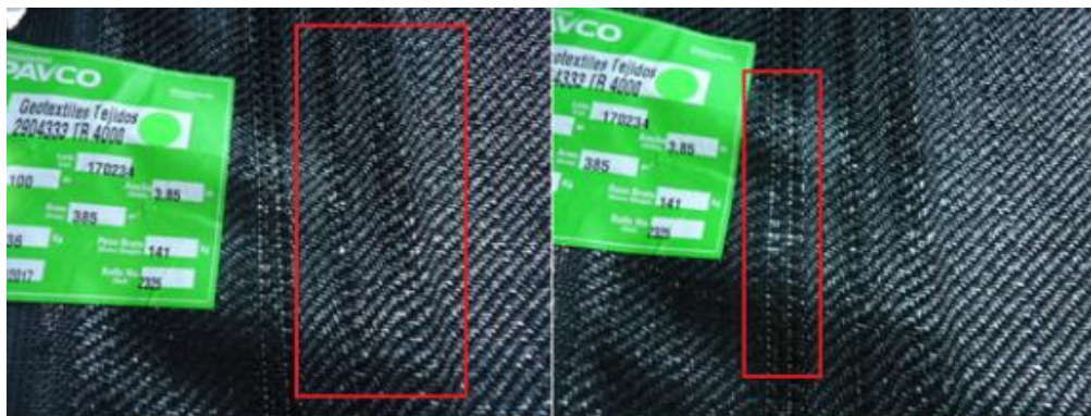
Ilustración 11. Falla de calidad, mal tejido. Fuente: PAVCO Wavin.
