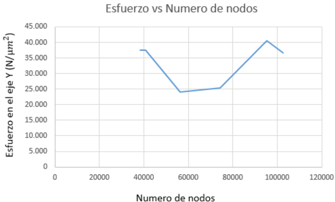
Figure 34: Variación del esfuerzo en el eje Y con respecto a la variación de la calidad del emallado. Fuente: el autor
