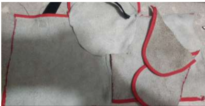
Figura 12: Tela de carnaza para la sofocación del foco de incendio. (Fuente de elaboración propia)
