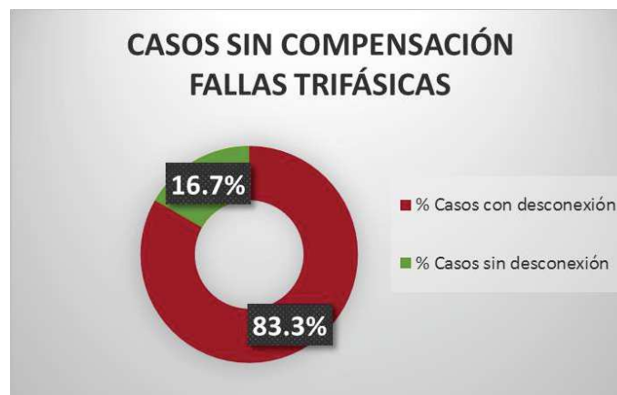
Figura 34. Porcentaje de casos con y sin desconexión ante fallas trifásicas de 5 \Omega , al 50% de la línea. (1.200 MW en S/E Colectora 1)
