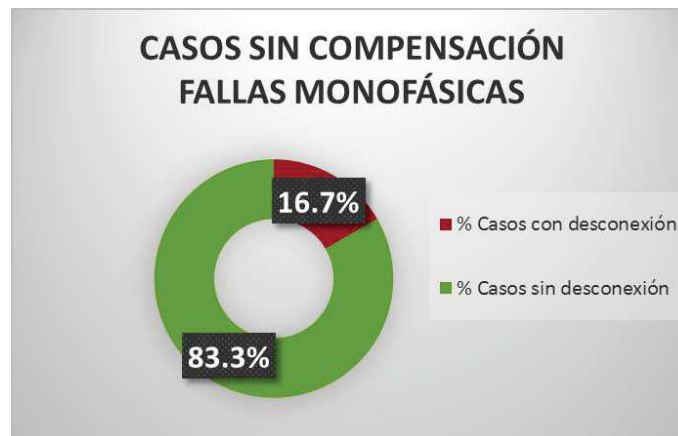
Figura 33. Porcentaje de casos con y sin desconexión ante fallas monofásicas de 5 \Omega , al 50% de la línea. (1.200 MW en S/E Colectora 1)
