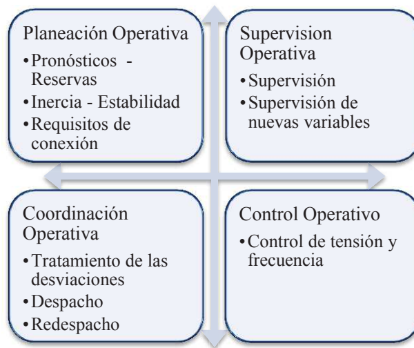
Figura 38. Retos operativos ante cambios en el SIN por la integración de generación eólica en Colombia.
