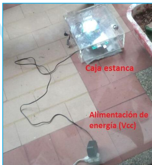
Ilustración 2. Prototipo de la EMA - UD en pruebas de correcto funcionamiento
