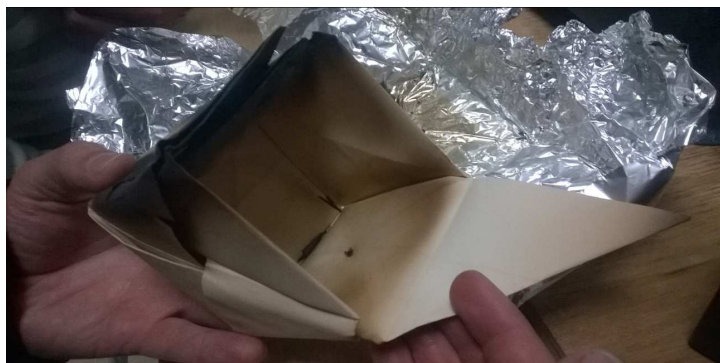
Foto 6. Cubo después de dos horas en la estufa.
